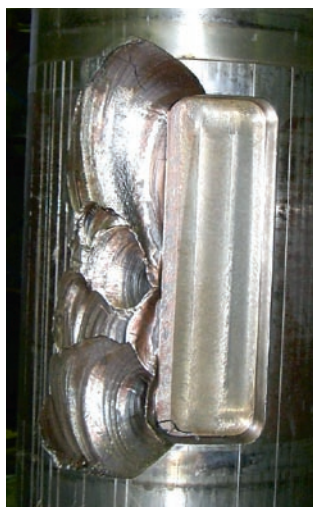
Getriebeüberwachung: Die Schädigung an der Passfedernut eines Wellenzapfens konnte so frühzeitig erkannt werden, dass deren Ausbruch und eine Folgeschädigung der Stirnräder verhindert wurde.
