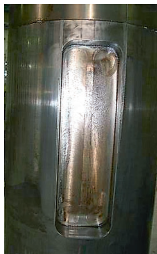
Getriebeüberwachung: Die Schädigung an der Passfedernut eines Wellenzapfens konnte so frühzeitig erkannt werden, dass deren Ausbruch und eine Folgeschädigung der Stirnräder verhindert wurde.
