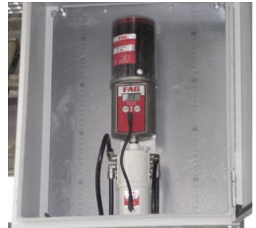
Das Mehrpunkt-Schmiersystem ist mit dem Schmierstoff Arcanol Multitop befüllt
