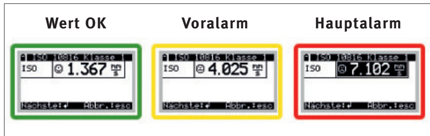
Symbole (Smileys) im Gerätedisplay ermöglichen eine schnelle Ergebnisinterpretation
